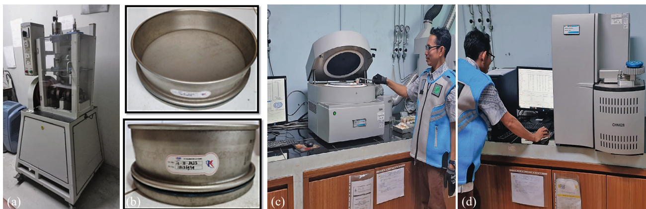
Figure 3: a) Raymond mill, b) 250 µm mesh sieve (Size 60), 3c) proximate analysis, 3d) ultimate analysis.
